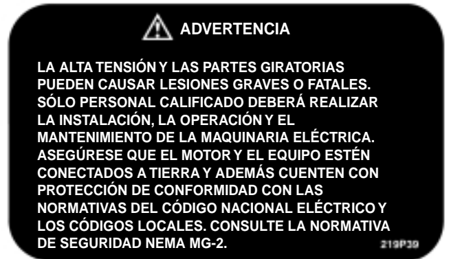
PLACA DE ADVERTENCIA ELÉCTRICA
