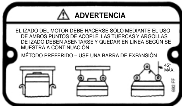
PLACA DE ADVERTENCIA DE IZADO
